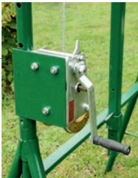
Montage der Handwinde auf der Grundplatte und dem Gerüstbock.
