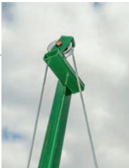
Das Drahtseil wird über die Umlenkrolle geführt und steuert die Hubstange.
