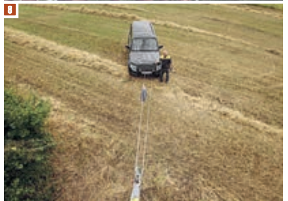
4 Hochstand-Aufstellen mit der Seilwinde (Bild 6, 7 und 8): Seilfang (Decke etc.) über das Seil legen; sollte es reißen, verfängt sich das Seil; Baumgurt, Schäkkel, Umlenckrolle für schwere Lasten.
