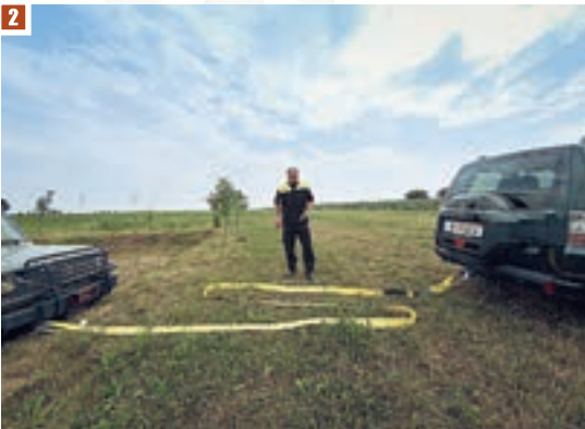
2 Benötigt das ziehende Auto einen „Anlauf“, ermöglicht dies ein elastischer Bergegurt (Seil und Ketten eignen sich nicht dazu) – der Gurt muss dazu s-förmig aufgelegt werden.
