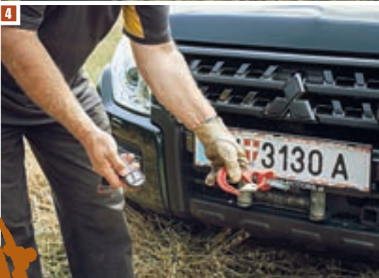
4 Hochstand-Aufstellen mit der Seilwinde (Bild 6, 7 und 8): Seilfang (Decke etc.) über das Seil legen; sollte es reißen, verfängt sich das Seil; Baumgurt, Schäkkel, Umlenckrolle für schwere Lasten.
