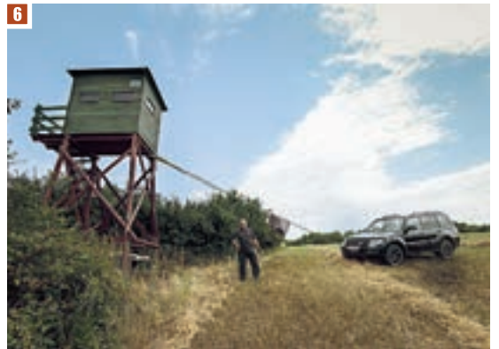
2 Benötigt das ziehende Auto einen „Anlauf“, ermöglicht dies ein elastischer Bergegurt (Seil und Ketten eignen sich nicht dazu) – der Gurt muss dazu s-förmig aufgelegt werden.
