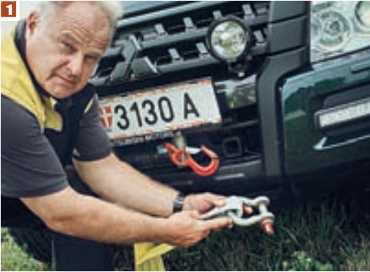
1 Bergegurt immer mit Schäkkel am Auto befestigen (Bruchlast mindestens 15 t).
