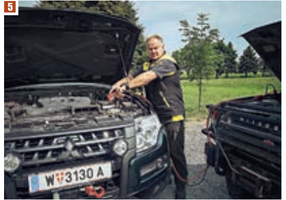
1 Bergegurt immer mit Schäkkel am Auto befestigen (Bruchlast mindestens 15 t).
