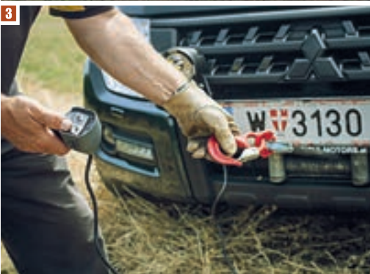
3 Verbaute Seilwinden sind 1. Wahl, das Seil soll dabei waagrecht aus der Winde herauslaufen. Eine Kabelfernbedienung hat einen kleinen Aktionsradius, eine kabellose Fernbedienung (Funk) ist für die Wildbringung ideal (Bild 3 und 4).
