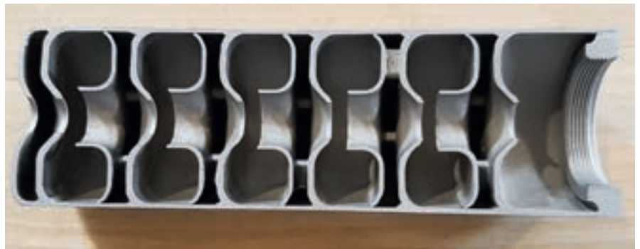
Querschnitt eines einfachen Schalldämpfers mit relativ kurzer Baulänge.
