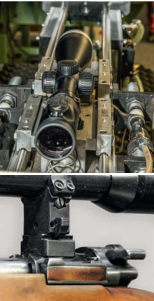
Bild oben: Auf Schockprüfungsmaschinen wird die Schussfestigkeit überprüft. Bild unten: Bereits ein Schlag auf diesen Druckknopf entriegelt die Montage – nicht handhabungssicher!
