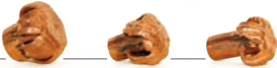
Bleifreie Deformationsgeschosse in deformiertem Zustand; annähernd 100% Geschossrestgewicht.
