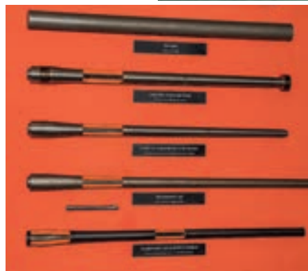
Die Arbeitsschritte bei der Entstehung des weltberühmten Steyr-Mannlicher-Laufes. Dadurch, dass der Lauf kaltgehämmert wird, erhält er seine Präzision und Widerstandsfähigkeit!
