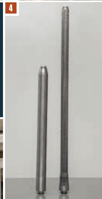
Die Arbeitsschritte bei der Entstehung des weltberühmten Steyr-Mannlicher-Laufes. Dadurch, dass der Lauf kaltgehämmert wird, erhält er seine Präzision und Widerstandsfähigkeit!
